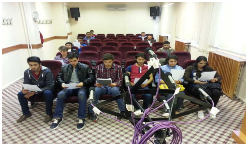
řekil 5.3. 8 elemanlı mikrofon dizisi ile konferans salonunda ses kaydı
