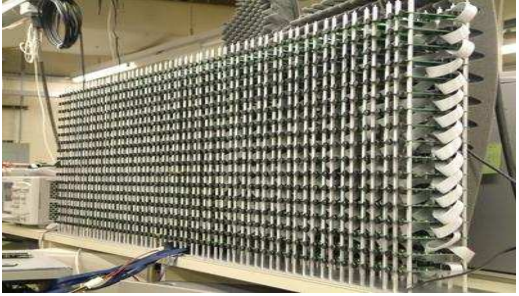
Şekil 2.4. MIT tarafından geliştirilen 1020 adet mikrofondan oluşan dünyadaki en büyük mikrofön dizisi(Çontar, 2007)
