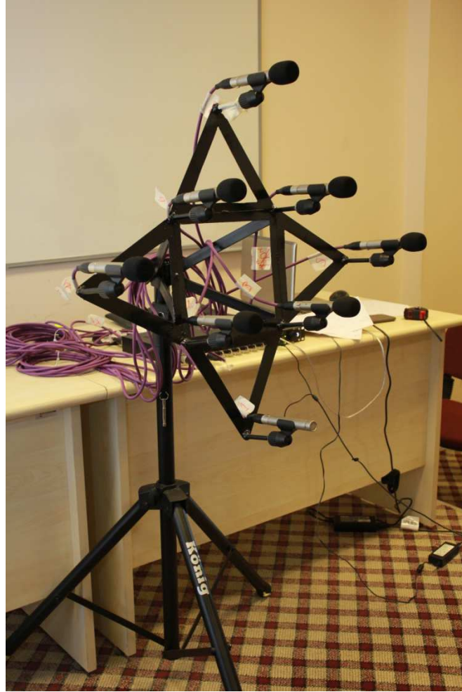
Şekil 4.1. Geliştirilen 8 Elemanlı mikrofona dizisi(FMD)
