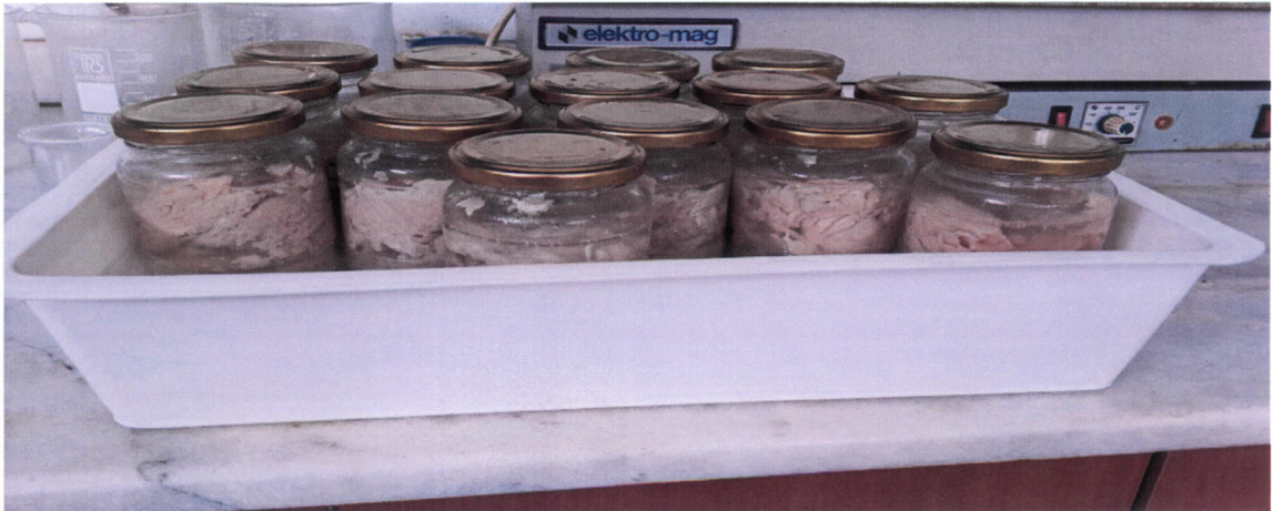
Şekil 3.4. Konservelerde egzost işlemi
