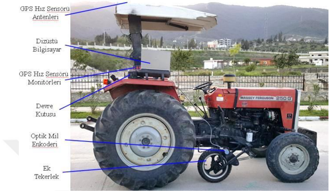
Şekil 3.3. Çalışmada kullanılan donanımının traktör üzerinde yerleşimi
