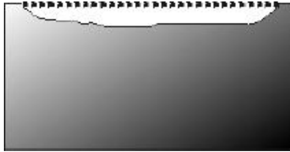
Şekil 1.2. Homojen dağılımlı korozyon ( www.corrosion-doctors.org )
