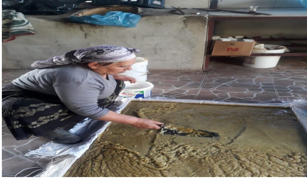
Fotoğraf 8: Kalıba dökülen sabunun mala yardımıyla düzeltilmesi
