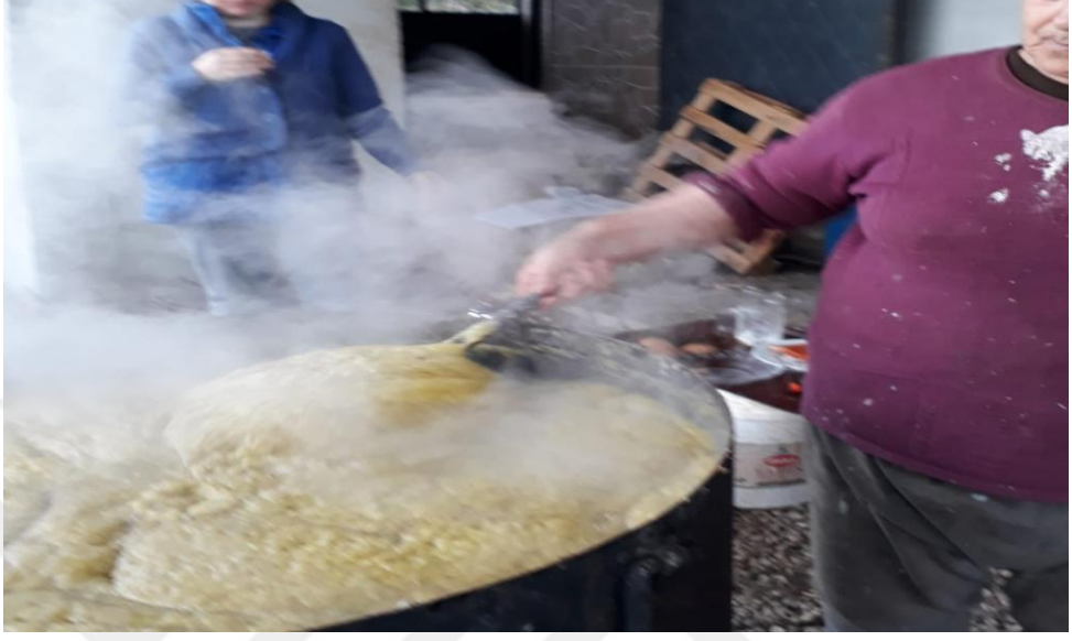
Fotoğraf 7: Defne yağının kostik ile katılaştırılarak sabun elde edilmesi
