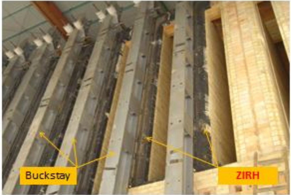
Şekil 4.10. Koklaşma Kamaraları, Buckstay ve Zırhlar
