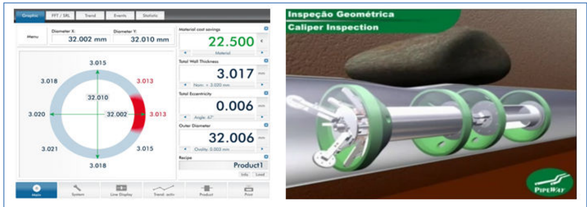
Şekil 4.18. Akıllı PİK'in Ölçtüğü Bir Kesit Daralması ve Programdaki Çıktı Görüntüsü (Aktaş, 2012)
