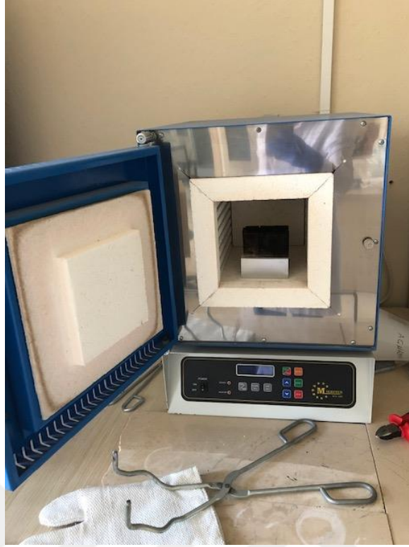
Şekil 3.20. HMKÜ’ de bulunan Mikrotek MFX 1005 model numune tavlama fırını
