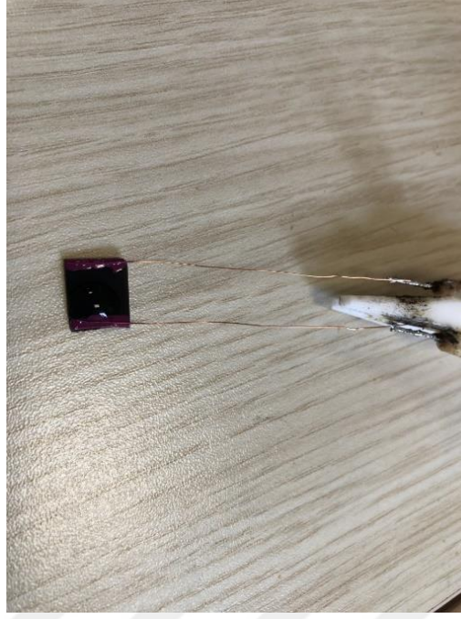
Şekil 3.28. Çalışmamızda kullanılan, üzerine ter damlatılmış bir ince film numunesinin görüntüsü
