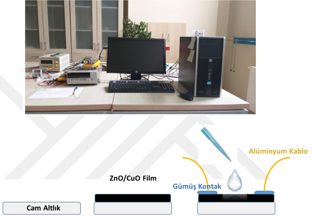
Şekil 3.27. Akım-zaman ölçüm sistemi görüntüsü ve oluşturulan kontak yapısının temsili gösterimi
