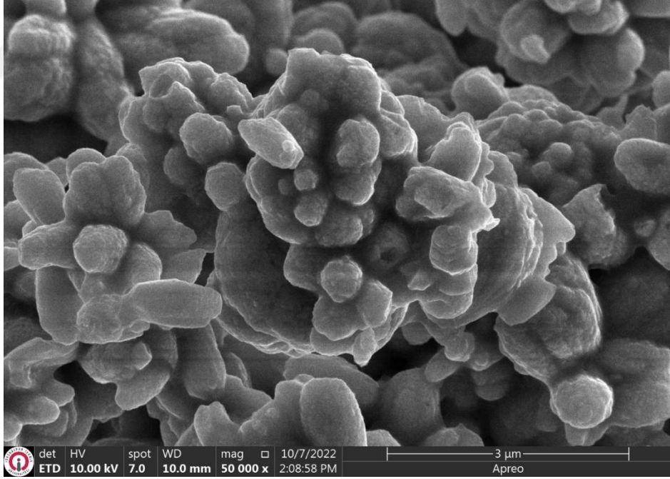
Şekil 4.12. %10,0 C. babylonica Katkılı ZnONPs 50 KX Büyütmedeki FESEM görüntüsü
