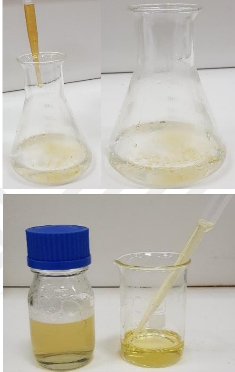
Şekil 3.5. Sürfaktant yardımıyla uçucu yağlardan mikroemülsiyon elde edilmesi
