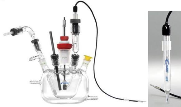
Şekil 3.4. Elektrodepolama hücresi ve referans elektrot (gamry.com)
