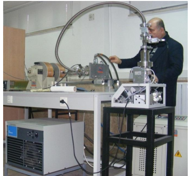
Şekil 3.36. Kapalı devre helyum soğutmalı öz direnç ölçme sistemine ait fotoğraflar
