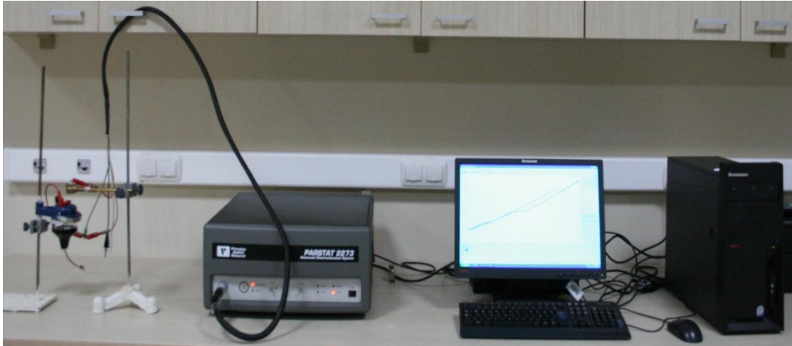
Şekil 3.5. Elektrokimyasal depolama düzeneği
