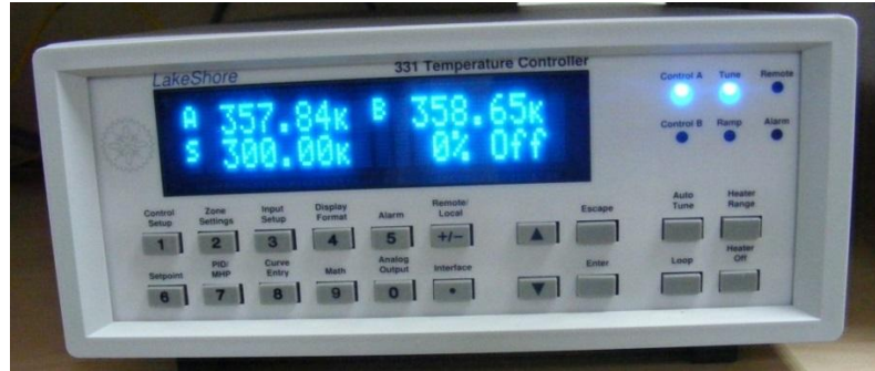
Şekil 3.33. Lake Shore 331 sıcaklık kontrol ünitesi
