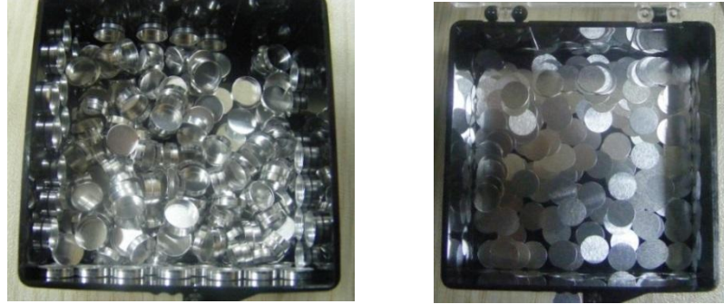
Şekil 3.17. Ölçme yapılacak örnekler için numune kabı altlığı ve kapağı (Pans)
