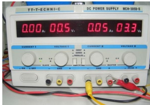
Şekil 3.10. Elektrokimyasal depolama deneyinde kullanılan sabit akım ve gerilim kaynağı, voltmetre ve ampermetre olarak kullanılan multimetre
