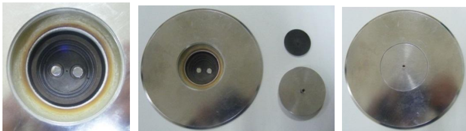
Şekil 3.20. Örnek numune ve referans numunenin DSC cihazına yerleşimi
