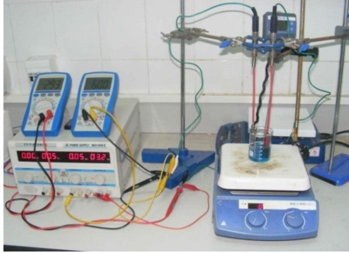
Şekil 3.9. Elektrokimyasal depolama sistemi deney düzeneği kurulumu fotoğrafı
