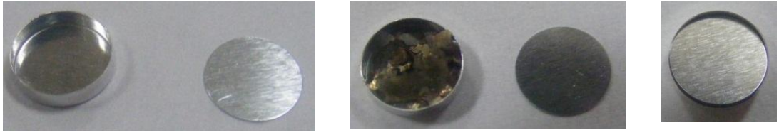
Şekil 3.18. Örnek numunenin preslemeye hazır hale getirilmesi
