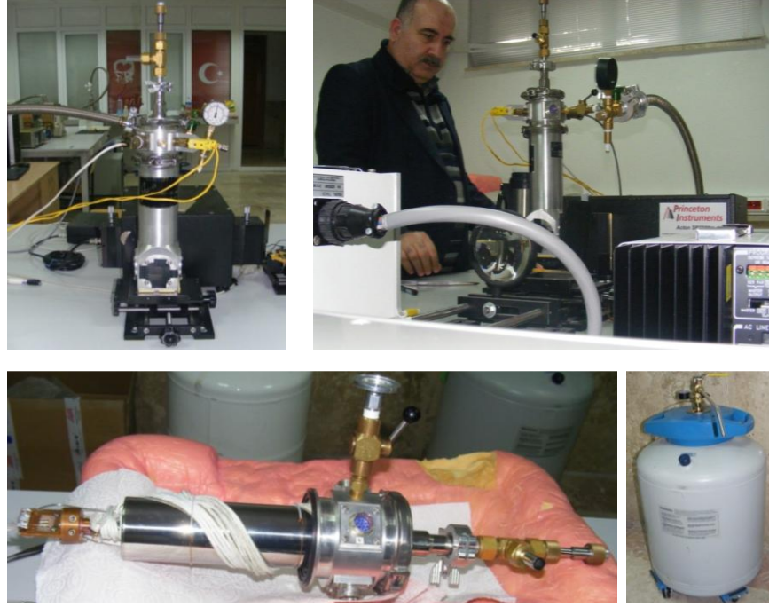
Şekil 3.38. Azot soğutmalı elektriksel özdirenç ölçme sistemi fotoğrafları
