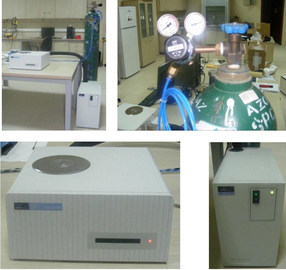
Şekil 3.16. DSC ölçme sistemi düzeneği ile birlikte sistemi oluşturan elemanların ayrı ayrı görünümü
