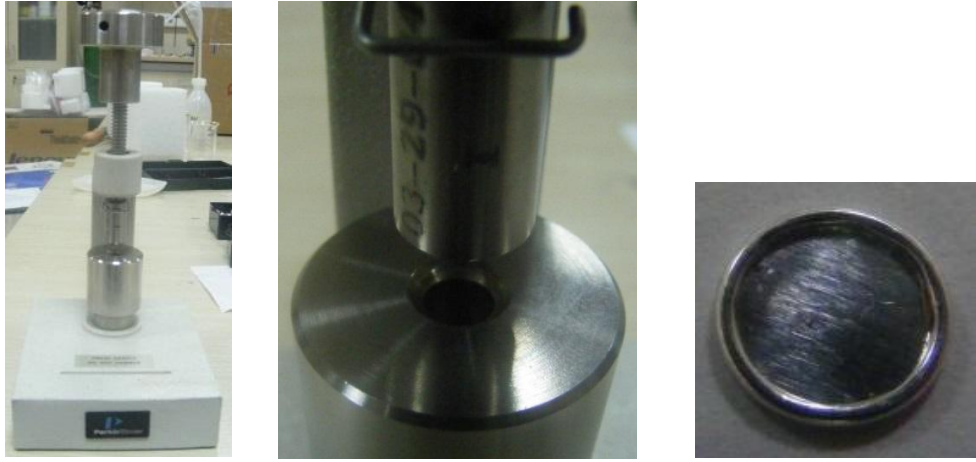
Şekil 3.19. Örnek numune pres aleti ve presleme
