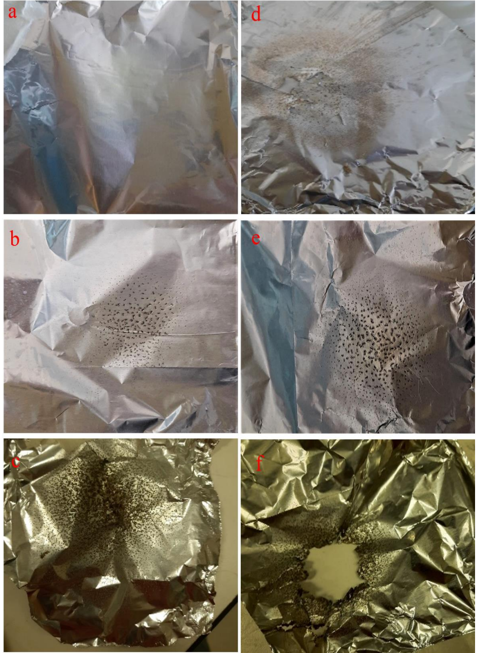
Şekil 4.15. %5 GP1 ile Al-folyo üzerinde EE üretilen liflerin dijital fotoğraf görüntüleri: ilk gün (a) üçüncü gün(b) 1 ay sonra (c), %7 GP1 EE üretilen liflerin üçüncü gün (d) bir hafta sonra (e) 3 ay sonra (f)
