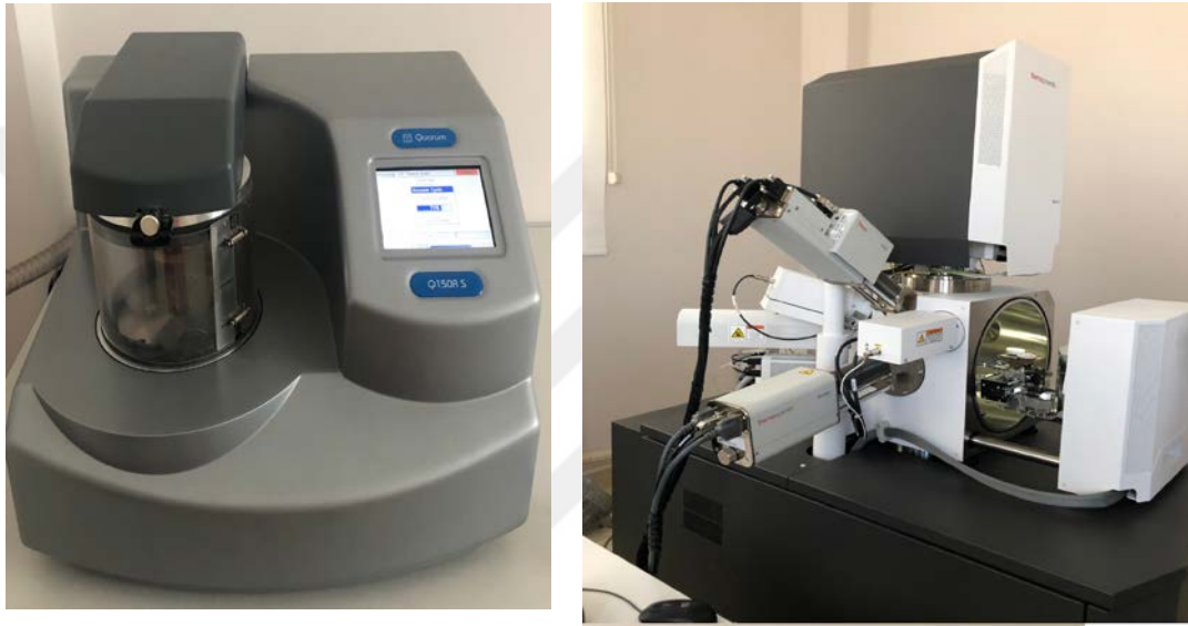
Şekil 3.11 Quorum Q150R S mıknatıssal saçırma kaplama cihazı ve Thermo Scientific Apreo S ve Ultradry Enerji Dağılımlı X-Işını Spektroskopisi Dedektörü
