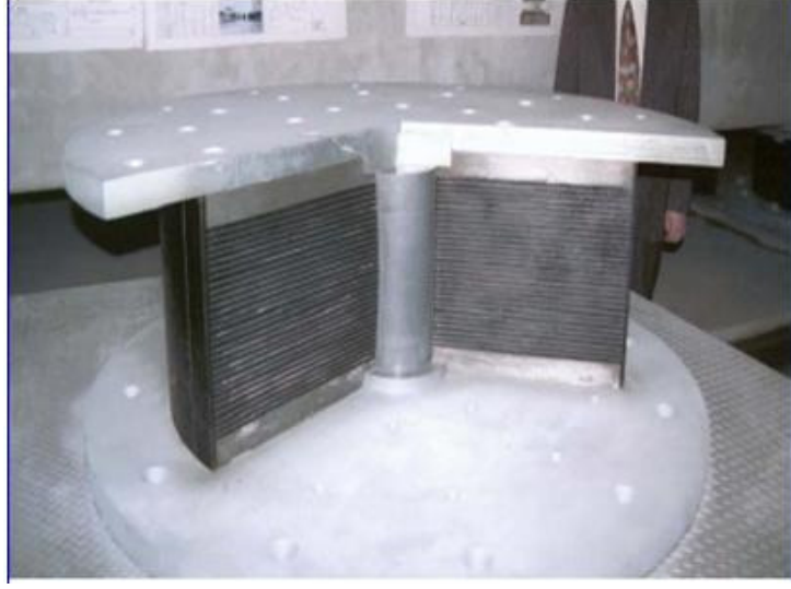
Şekil 3.6. Kurşun Çekirdekli Kauçuk Mesnet Kesiti
