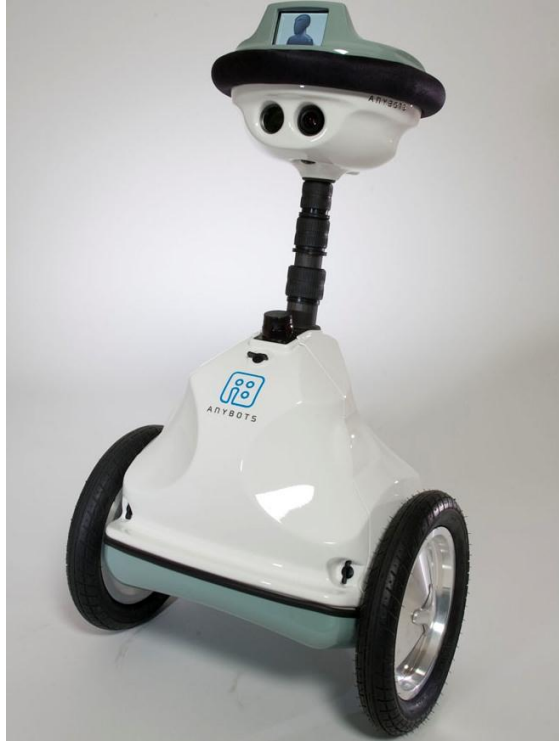
Şekil 2.2. Telepresence: Uzaktan konferans robotu (Anonymous, 2014)
