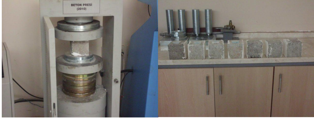
Şekil 3.3. Yığma duvar örme harcı numuneleri ve testleri
