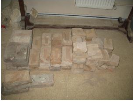
Şekil 3.2. Duvar elemanı olarak kullanılan harman tuğlası ve test edilmek üzere hazırlanan numuneler
