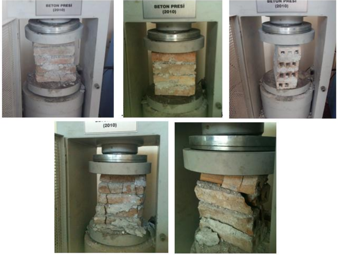
Şekil 3.5. Basınç kuvveti altında duvar elemanlarının test edilmesi
