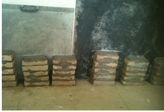
Şekil 3.4. Eksenel basınç altında test edilmek üzere hazırlanan duvar elemanları
