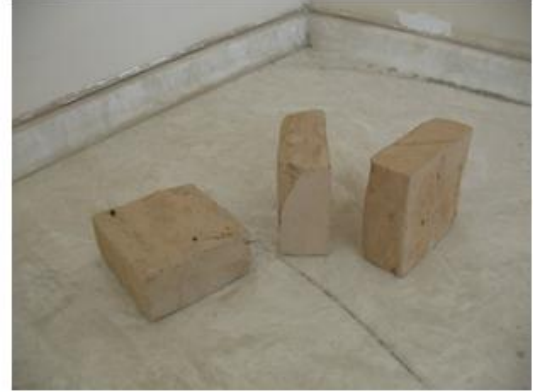
Şekil 3.2. Duvar elemanı olarak kullanılan harman tuğlası ve test edilmek üzere hazırlanan numuneler
