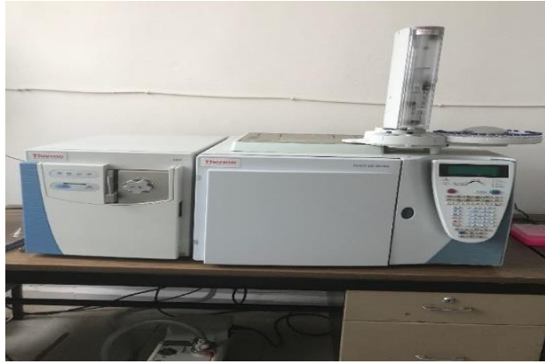
Şekil 3.2. Gaz kromatografisi-kütle spektrometresi (Thermo Fisher Scientific, ABD)
