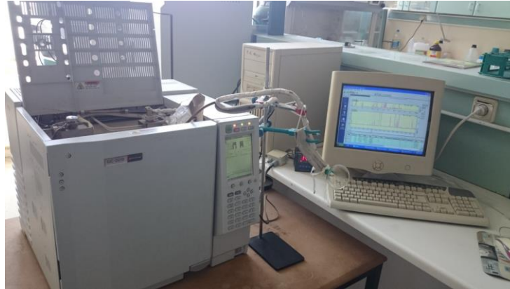
Şekil 3.3. Gaz kromatografisi-olfaktometri (Shimadzu GC2010, Japonya).
