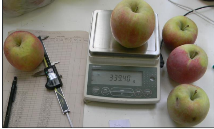
Şekil 3.19. Meyve ağırlığı ve irilik ölçümlerinden bir görünüm
