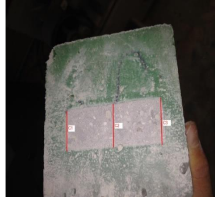
Şekil 8. Aşınma Dayanımı Deney Numunesi
