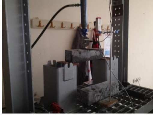
Şekil 3. Eğilme Dayanımı Deneyi Düzenegi
