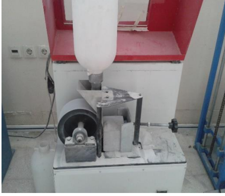
Şekil 7. Aşınma Dayanımı Deney Düzeneği
