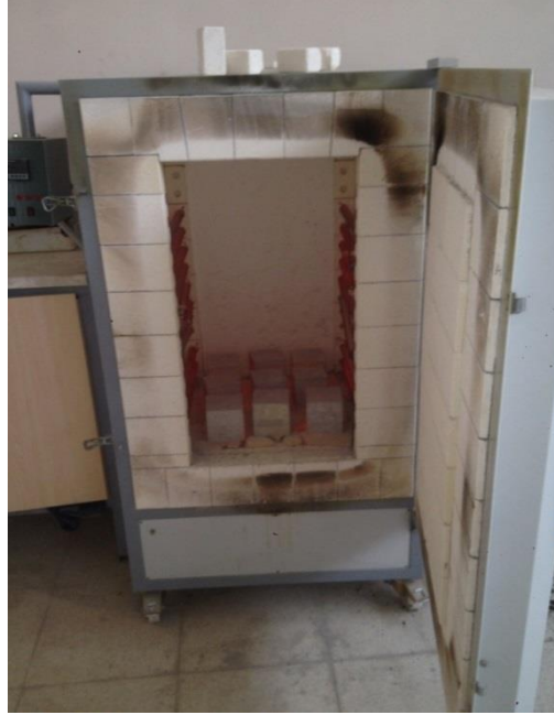
Şekil 6. Yangın Dayanımı Deneyi Düzeneği
