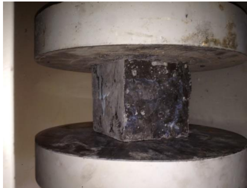
Şekil 2. Beton Basınç Deneyi Düzeneği
