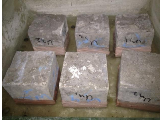
Şekil 4. Kapilarite Deneyi Düzenegi
