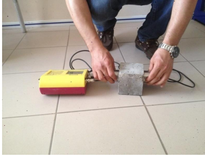
Şekil 9. Ultrasonik Ses Frekansı Deneyi Düzenegi
