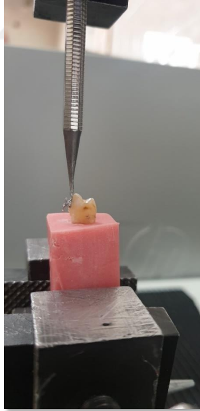
Şekil 3.20 Örneklerin instron cihazına yerleştirilmesi
