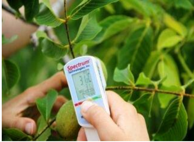
Şekil 3.7. Infa red termometre ile meyve yüzey sıcaklığı ölçüm görüntüsü
