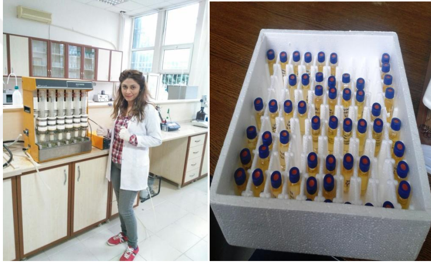
Şekil 3.18. Soxholet cihazında yapılan yağ analizi görünümü
