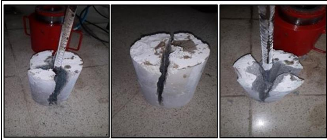
Şekil 15. Numunelerin çekip çıkarma deneyinde kırılma şekli
