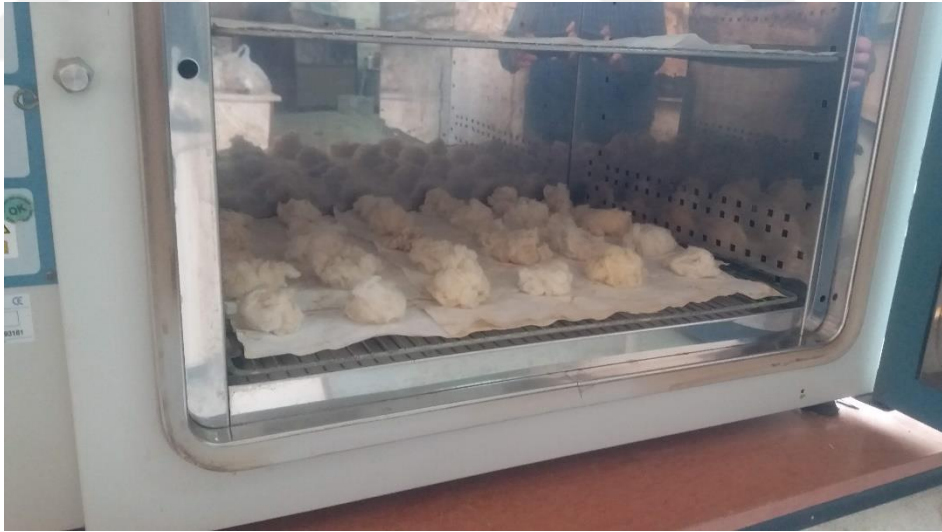
Şekil 3.2. Yapağının etüvde kurutulması
