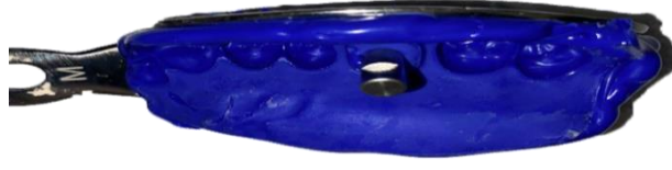
Şekil 3. 11. Ölçü Postu – Analog Birleşiminin Ölçü Üzerindeki Negatifine Yerleştirilmesi
