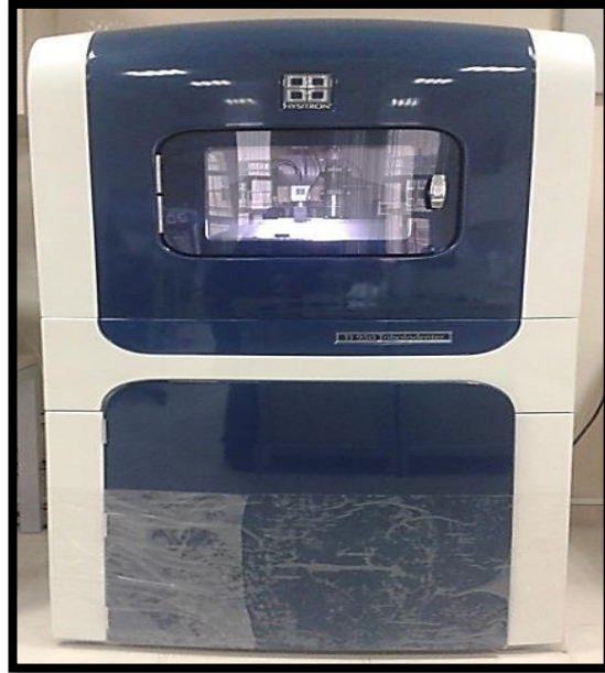
Şekil 3.12. Sertlik deneyleri için kullanılan TI 950 TriboIndenter test cihazının genel görünümü
