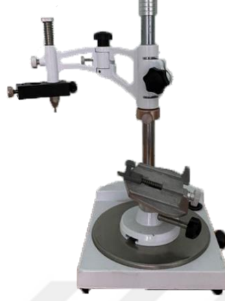
Şekil 3. 2. İmplantların yerleşiminde kullanılan paralelometre
