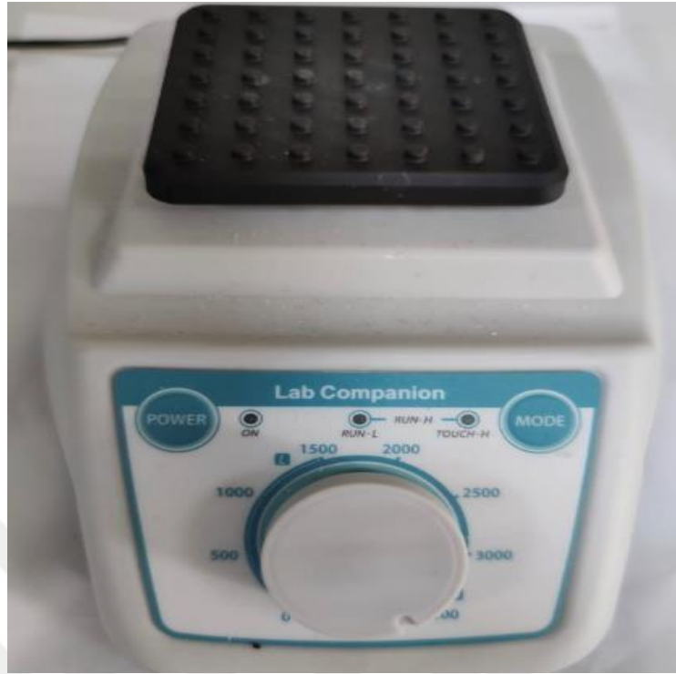
Şekil 3.3. Vorteks cihazı: Mikrobiyolojik analizler için örneklerin homojenize edilmesinde kullanılmıştır.
