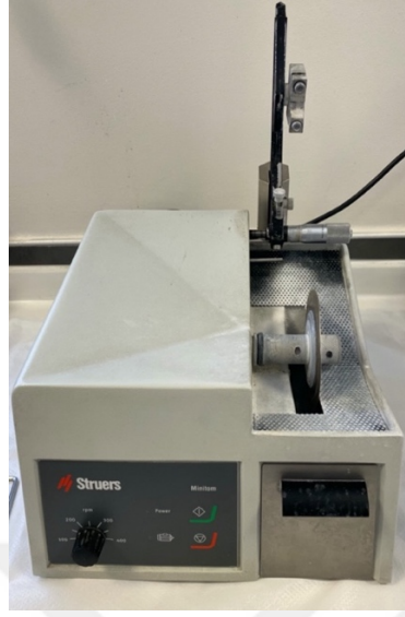
Şekil 3.4. CAD/CAM bloklarından örneklerin hazırlandığı hassas kesme cihazı
