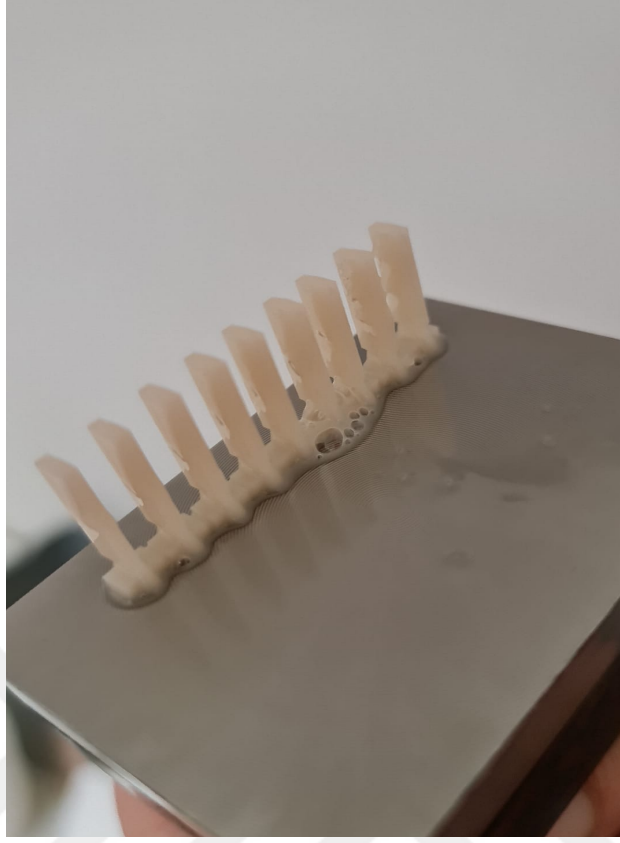
Şekil 3.7. 3B yazıcıdan platforma dik şekilde üretilen örnekler
