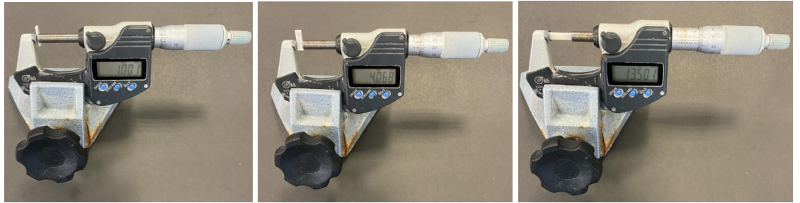
Şekil 3.11. Örnek boyutlarının ölçümleri yapılan mikrometre
