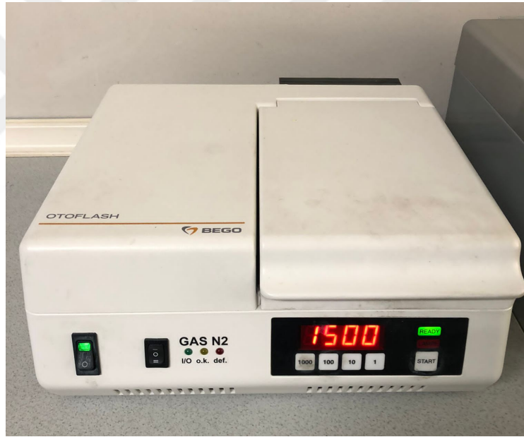
Şekil 3.9. 3B yazıcı ile üretilen örneklerin kürleme işleminin yapıldığı cihaz
