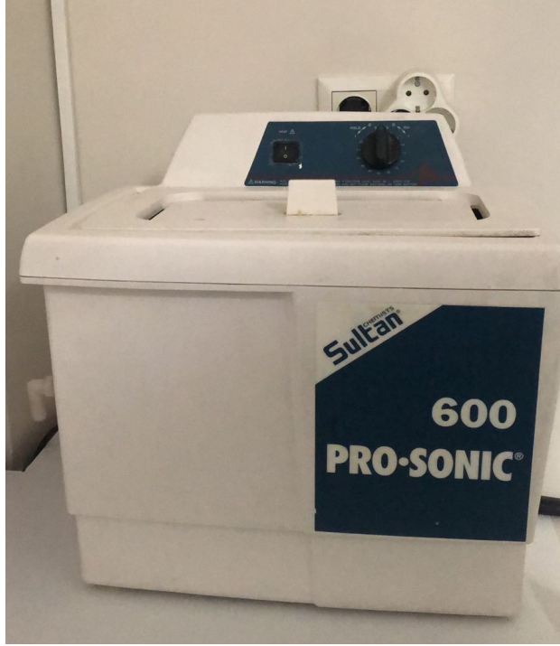
Şekil 3.8. 3B yazıcı ile üretilen örneklerin temizlendiği ultrasonik temizleme cihazı
