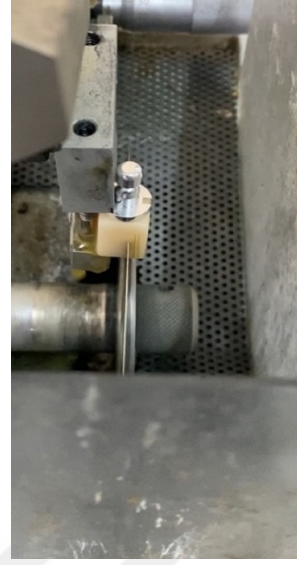
Şekil 3.4. CAD/CAM bloklarından örneklerin hazırlandığı hassas kesme cihazı
