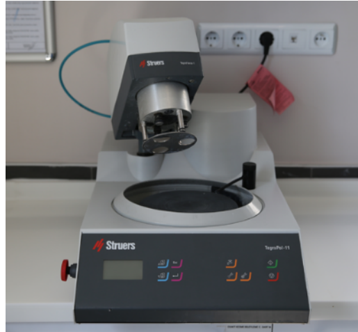
Şekil 3.5. CAD/CAM bloklarından elde edilen örneklerin polisajının yapıldığı parlatma cihazı
