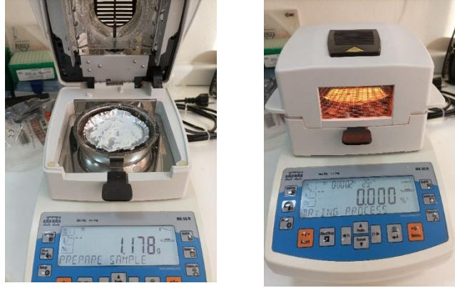
Şekil 3.2. Nem tayin cihazı (MA.X2.A, Radwag, Polonya).
