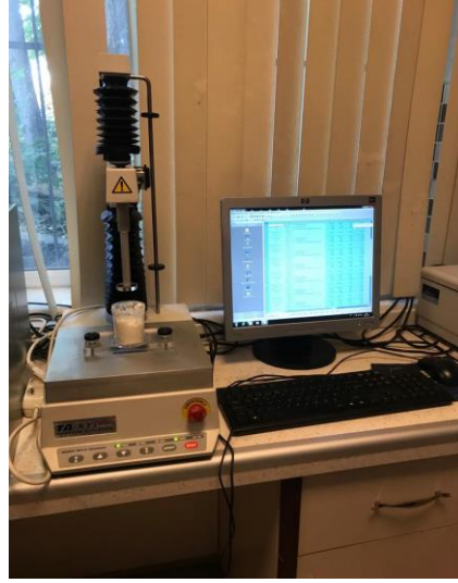
Şekil 3.4. Tekstür profil cihazı (TA-XT Plus, Stable Micro Systems, Surrey, UK)
