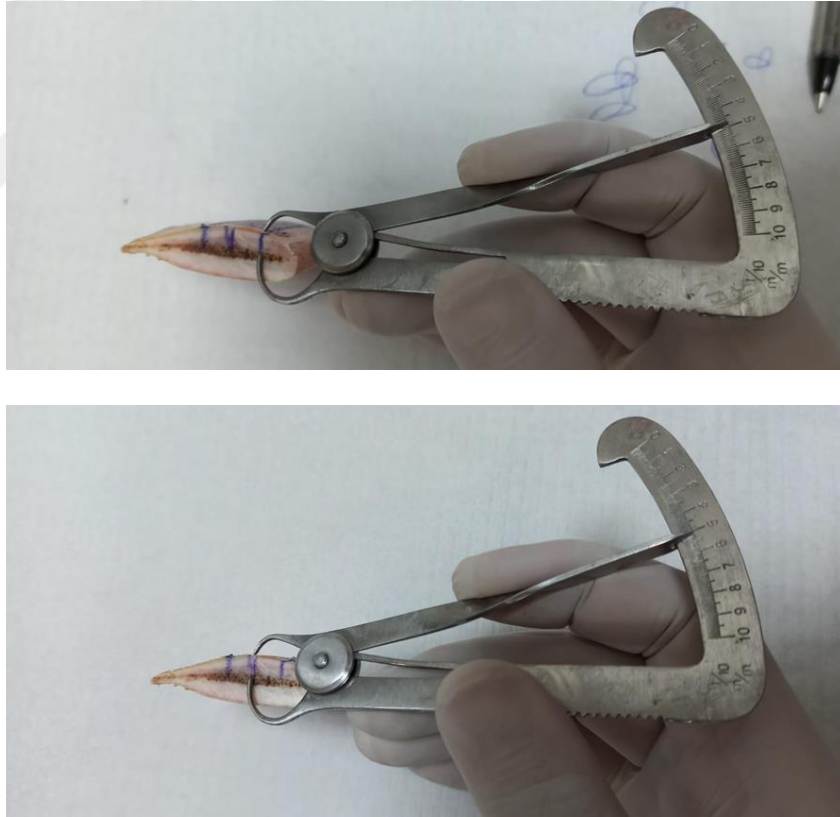
Şekil 3.2. Kemik bloğunun kortikal kalınlığının farklı noktalardan kumpas ile belirlenmesi
