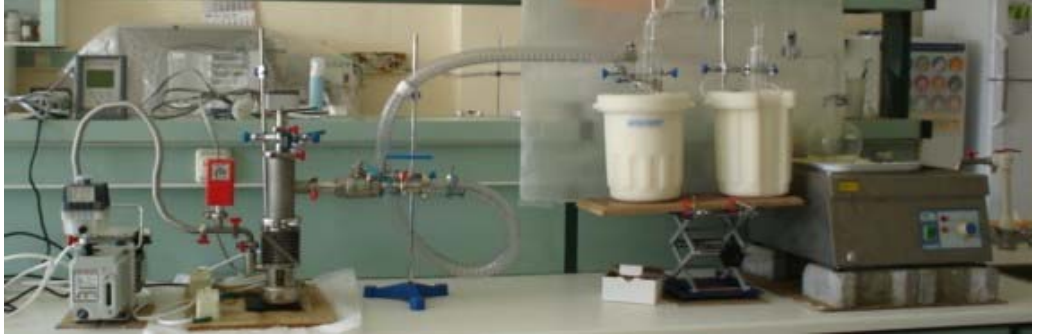
Şekil 3.3. Yüksek vakum distilasyon aparatı.
