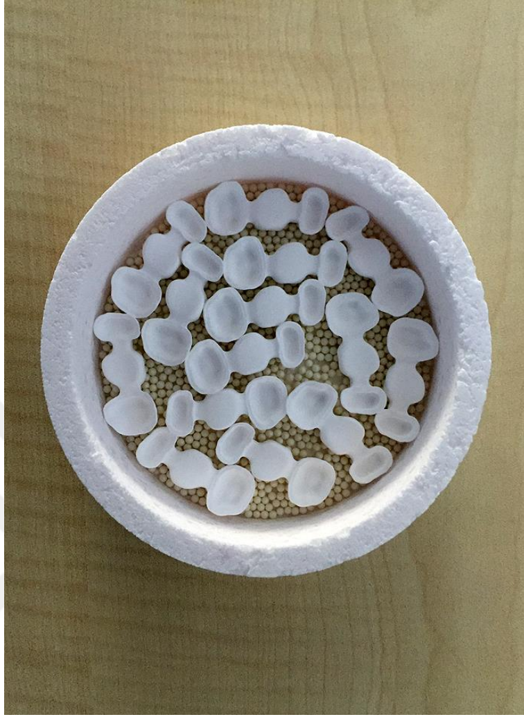
Resim 23: Kazınmış bloklardan ayrılmış zirkonyum altyapıların sinterleme işlemi öncesi görünümü
