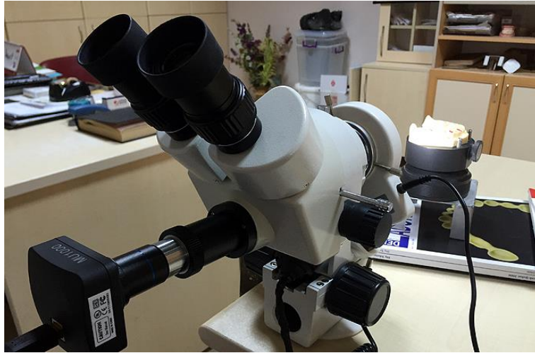
Resim 36: Yatay sabitlenmiş mikroskop ve çalışma modeli düzeneği
