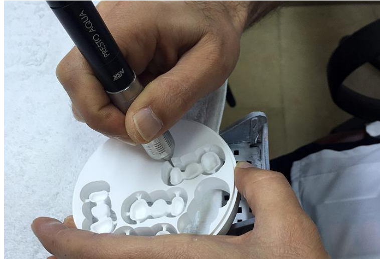
Resim 22: Restorasyonları kazınmış zirkonyum bloktan ayırma işlemi
