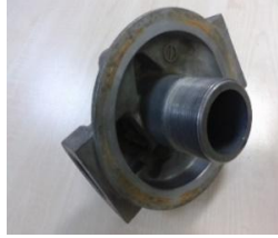
Şekil 3.10. Kullanılan yağ filtresinin araçtaki yuvası
