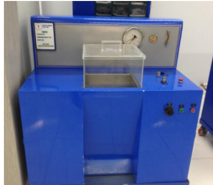
Şekil 3.14. Statik patlatma basınç deneyi test standı
