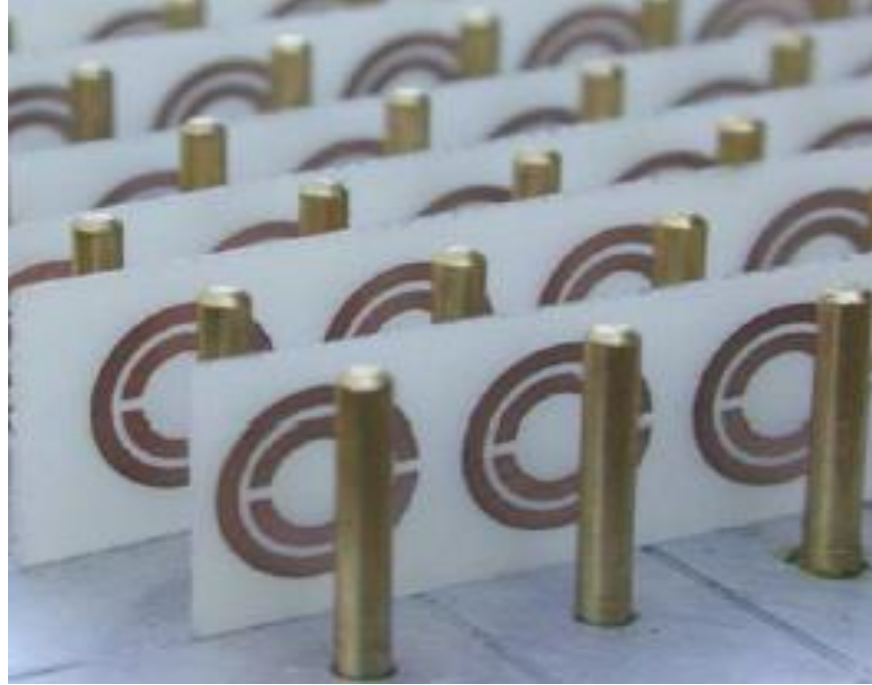
Şekil 1.1. Eş zamanlı negatif \epsilon ve \mu değerlerine sahip ilk üretilen metamalzeme
