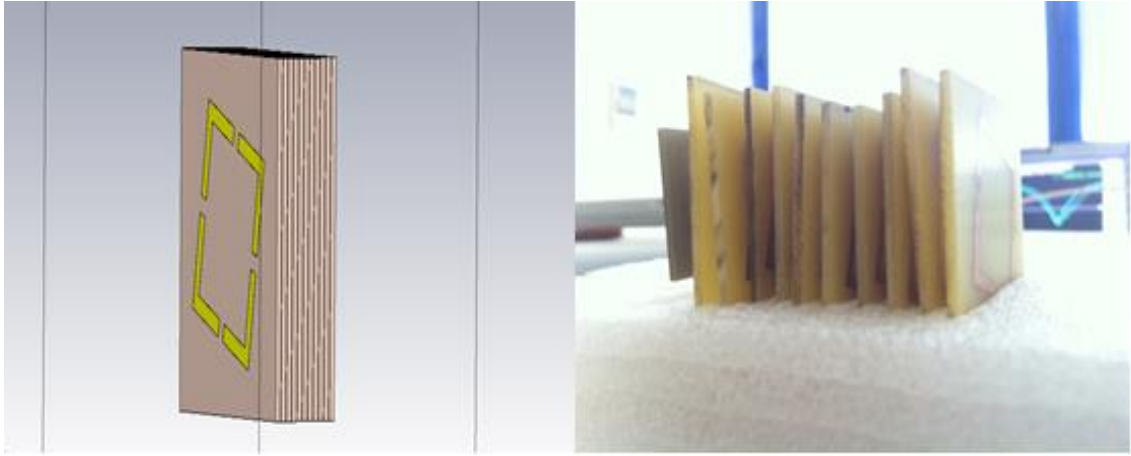
Şekil 4.126. Kare şekilli rezonatör eklenmiş yama anten için (sol-taraf) simülasyon ve (sağ-taraf) deneysel yapı
