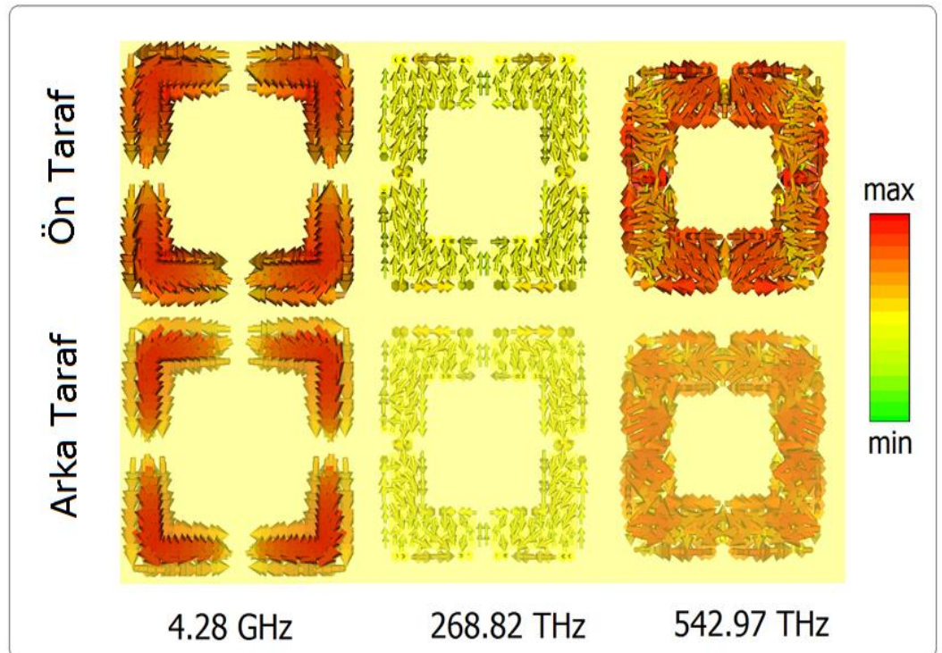
Şekil 4.124. Mikrodalga, kızıl ötesi ve görünür bölge için rezonans frekansındaki yüzey akım dağılımları
