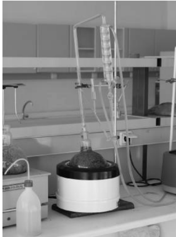
Şekil 3.3. Uçucu yağ eldesinde kullanılan mantolu ısıtıcı ve neo-clevenger
