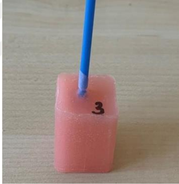
Şekil 3.12. Örneklerin akrilik rezine gömülmesi sonucu elde edilen model
