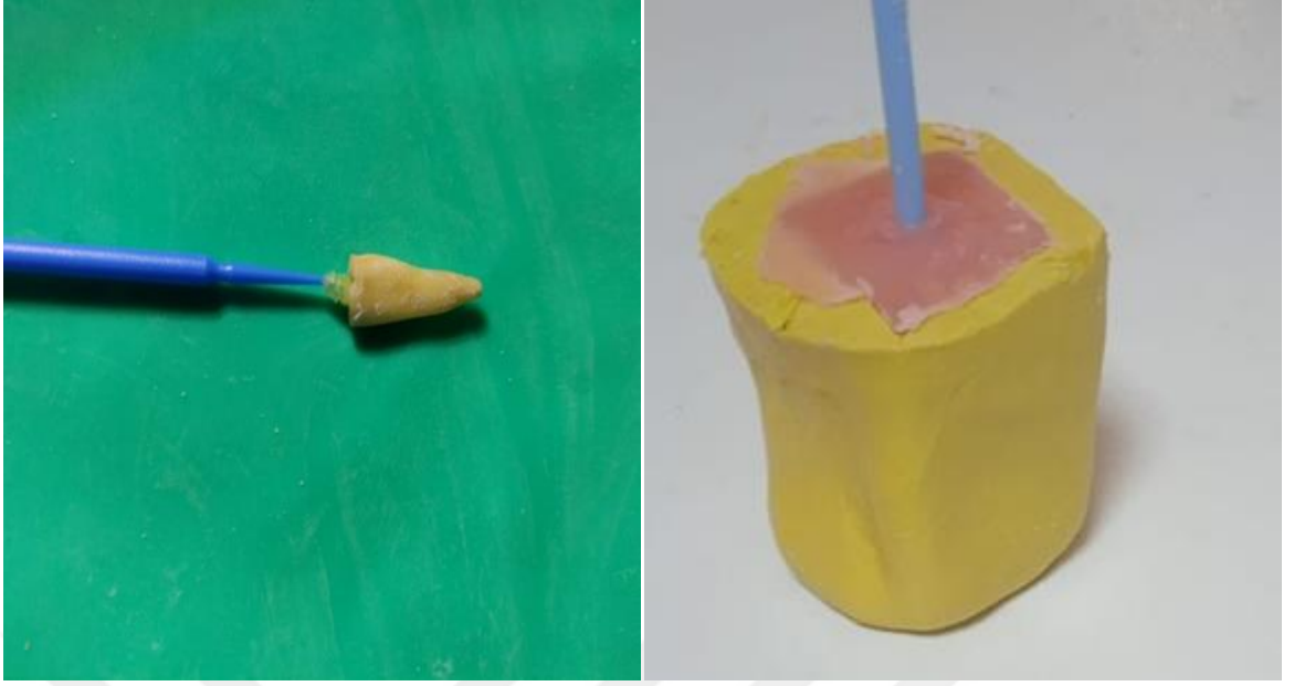
Şekil 3.11. Sırasıyla, örneklerin siyanoakrilat ile plastik çubuklara yapıştırılması ve akrilik rezine gömülmesi
