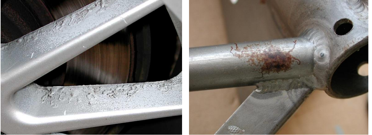
Şekil 1.4 Atmosferik ortamda ipliğimsi korozyonuna uğramış organik boyayla boyanmış parçalar
