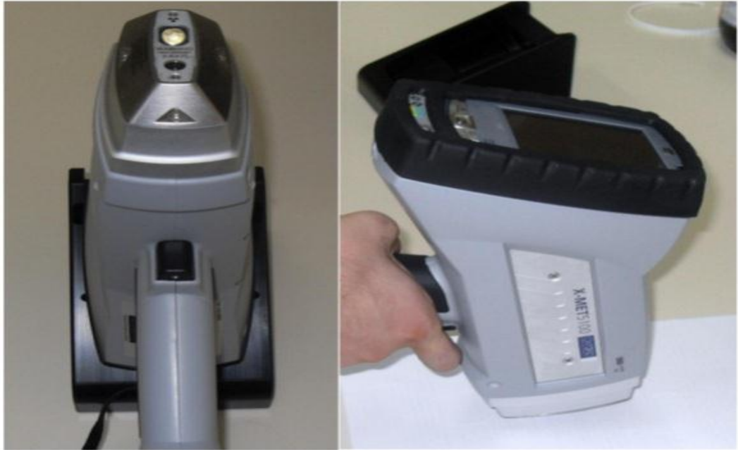
Şekil 3.17 X-Met 5100 marka Portatif XRF cihazı
