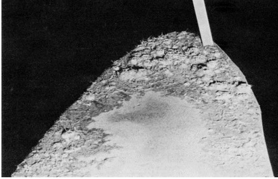
Şekil 1.9 Mikrobiyolojik korozyona uğramış bir parça
