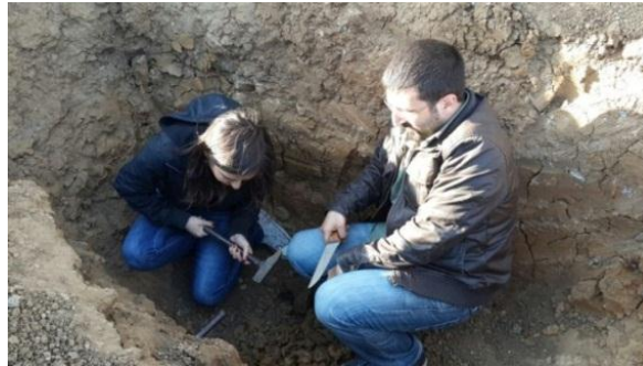
Şekil 3.5. Deneme alanı toprağının hacim ağırlığının belirlenmesi işlemi
