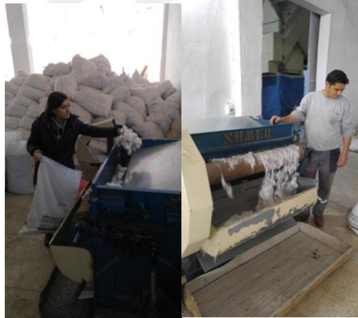
Şekil 3.20. Roller-Gin çırçır makinesi ve çırçırlama işleminden görünüm
