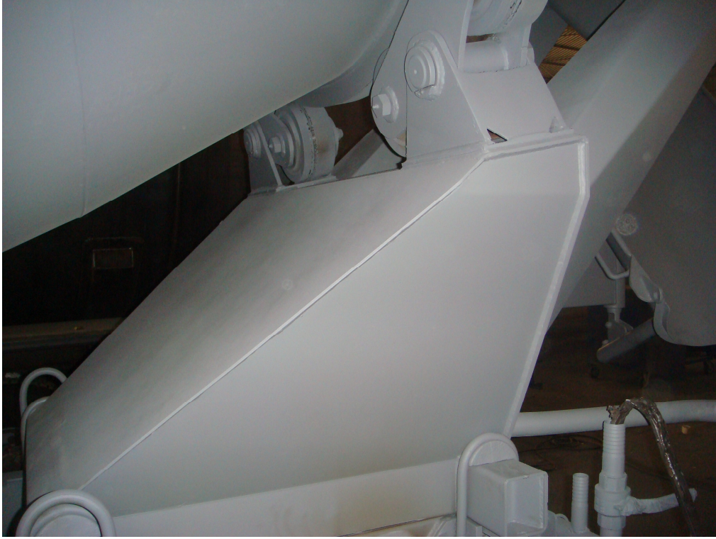
Şekil 6.13. Üretilmiş ele alınan taşıyıcı arka konsol
