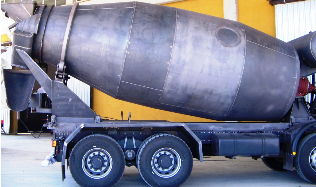
Şekil 6.7. Üretim aşamasındaki transmikser
