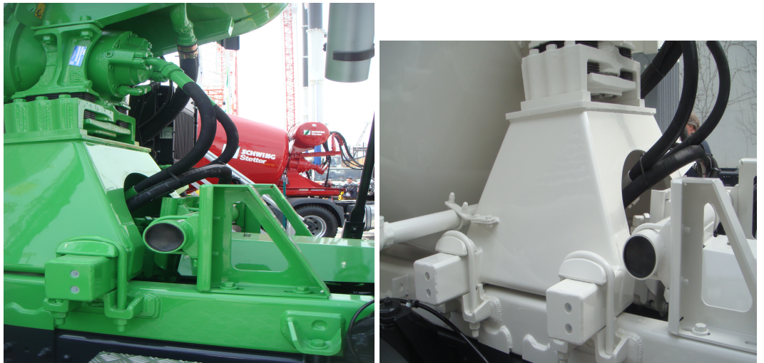
Şekil 7.20. Üretilmiş geliştirilen taşıyıcı ön konsollar
