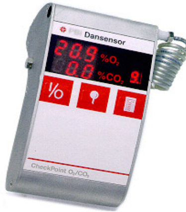
Şekil. 3.5. Gaz analizörü (PBI Dansensor, Danimarka)
