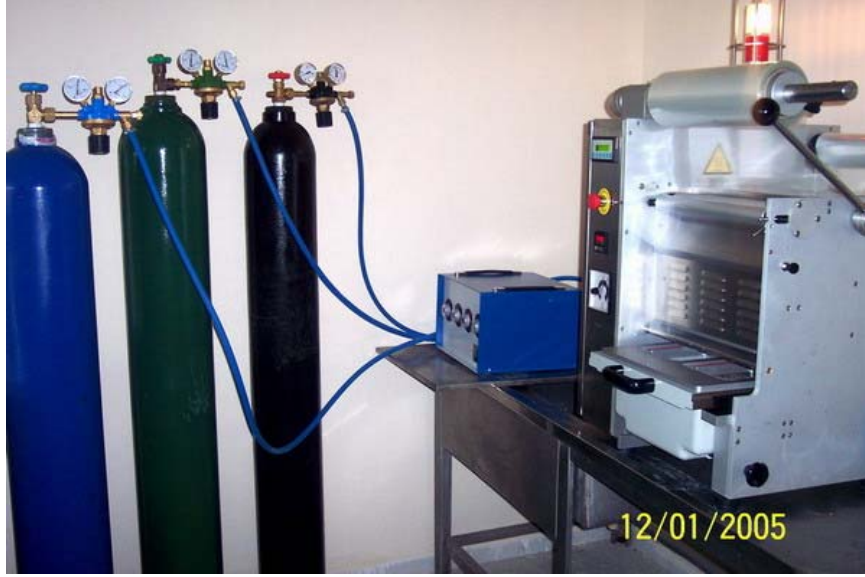
Şekil.3.4. Ambalajlama makinesi (MECA 501, Fransa) ve üçlü gaz mikseri (Witt, KM60-3, Almanya)
