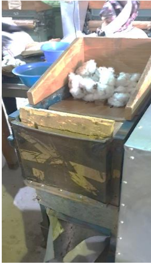
Şekil 3.19. Rollergin deneme çırçır makinası
