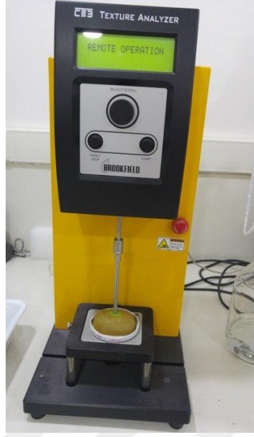
Şekil 3.3. Hayward kivi meyvesinde meyve eti sertliği ölçümü
