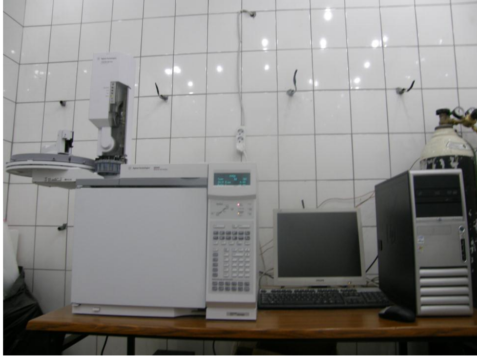
Şekil 3.2. Bakteri izolatların Yağ asit metil ester profillerine göre teşhis etmekte kullanılan MIS (Microbial Identification System)' in genel görünümü
