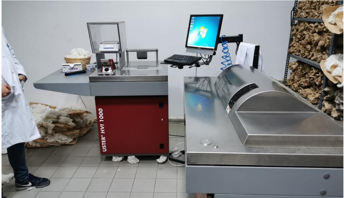
Şekil 3.7. HVI cihazı ile lif teknolojik özelliklerinin incelenmesi
