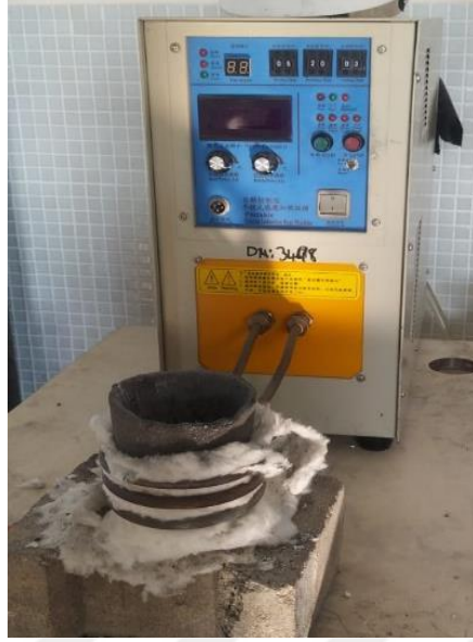
Şekil 3.3. İndüksiyon ergitme fırınında silisyum karbür pota görüntüsü
