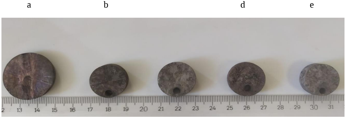
Şekil 4.13. (a) TY1, (b) TY2, (c) TY3, (d) TY4 ve (e) TY5 numunelerinin 168 saat HBSS içinde bekletildikten sonraki görüntüsü
