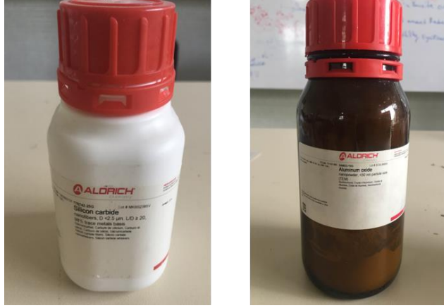
Şekil 3.5. Mg-Sn-Y alaşımına eklenen a) SiC nanofiber, b) nano Al 2 O 3
