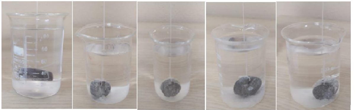
Şekil 4.12. (a) TY1, (b) TY2, (c) TY3, (d) TY4 ve (e) TY5 numunelerinin 96 saat HBSS içinde bekletildikten sonraki görüntüsü
