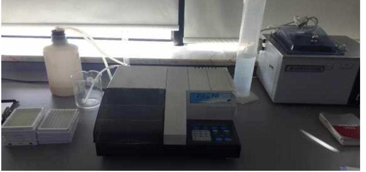
Şekil 3.1. Kortizol analizi esnasında kullanılan ELISA yıkama ünitesi
