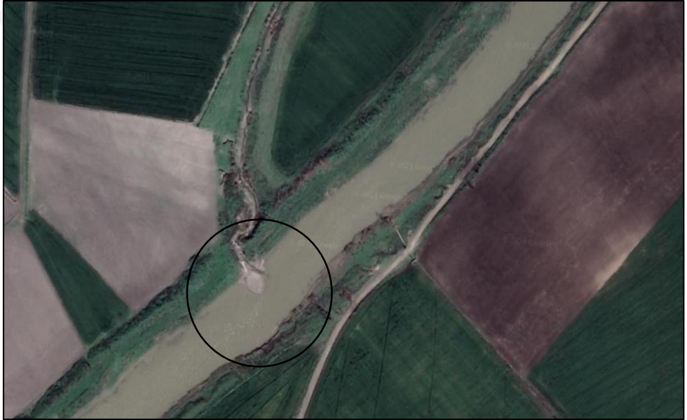
Şekil 4.38. Beş nolu istasyonda kanal kesiti daralması
