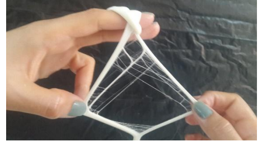
Şekil 4.2. Sünebilirlik ve liflenmenin geleneksel olarak kontrolü. a, sünmenin oluşup liflenmenin başlamadığı örnek; b, hem sünmenin hem de liflenmenin oluştuğunu örnek
