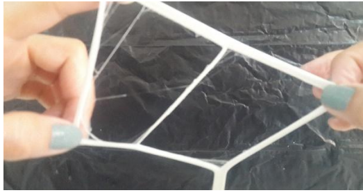
Şekil 4.2. Sünebilirlik ve liflenmenin geleneksel olarak kontrolü. a, sünmenin oluşup liflenmenin başlamadığı örnek; b, hem sünmenin hem de liflenmenin oluştuğunu örnek
