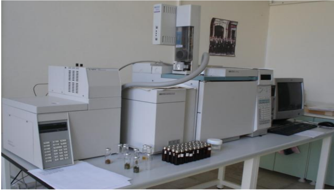
Şekil 3.3. Gaz kromatografisi-kütle spektrometresi (HP6890, Agilent, USA).
