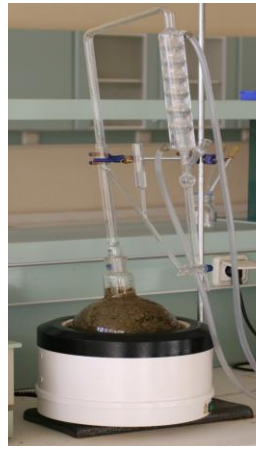
Şekil 3.5. Mantolu ısıtıcı ve neo-clevenger
