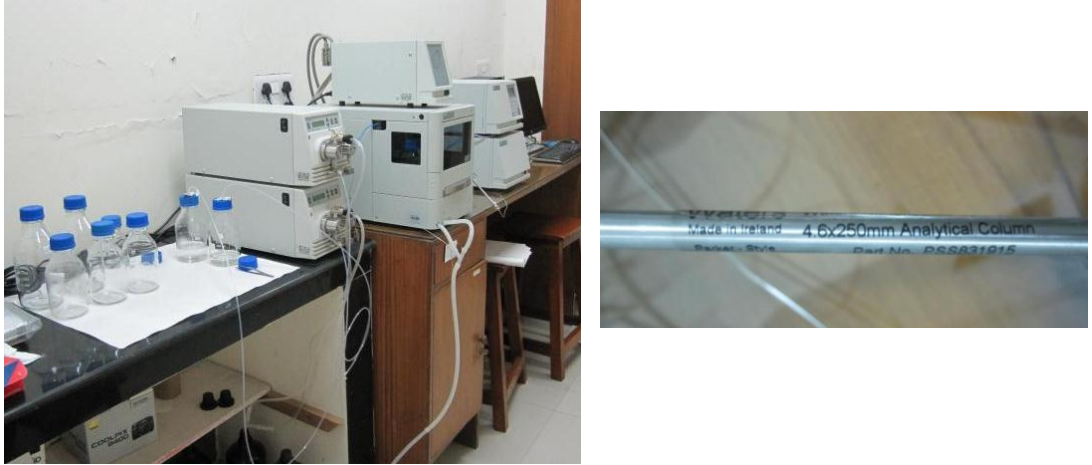
Şekil 3.12. HPLC aleti ve C 18 (4.60 x 250 mm) kolon
