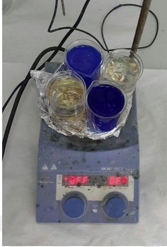
Şekil 3. 4.SILAR deney düzeneği görüntüsü.
