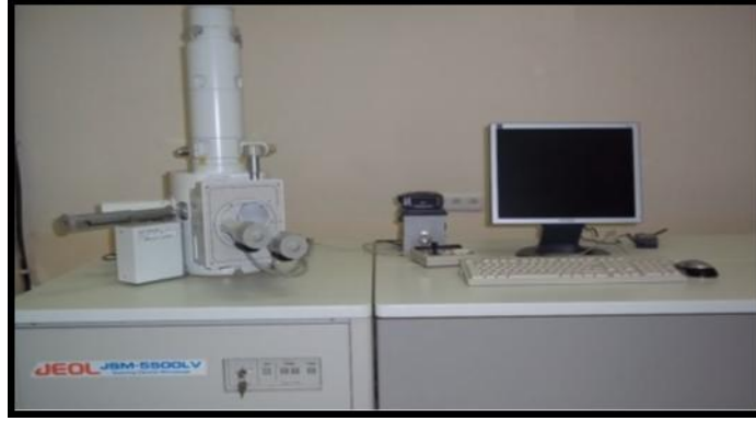
Şekil 3. 5. Mustafa Kemal Üniversitesi Teknoloji ve Ar-Ge Uygulama ve Araştırma Merkezinde bulunan Jeol marka JSM-5500LV Taramalı Elektron Mikroskobu (SEM)
