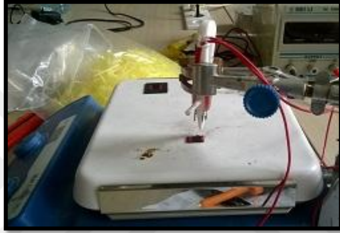
Şekil 3. 7. Akım-zaman ölçüm işleminde kullanılan kontak sistemi.
